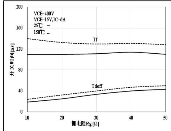
图 8 关断-栅电阻特性曲线
