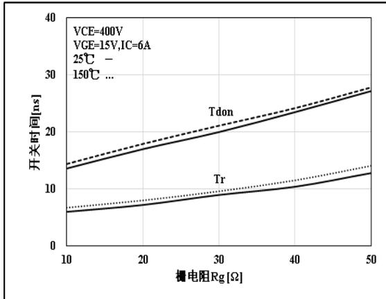
图 7 开通-栅电阻特性曲线
