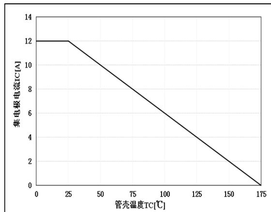
图 16 集电极电流温度特性
