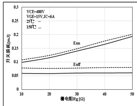
图 6 开关损耗-栅电阻特性曲线
