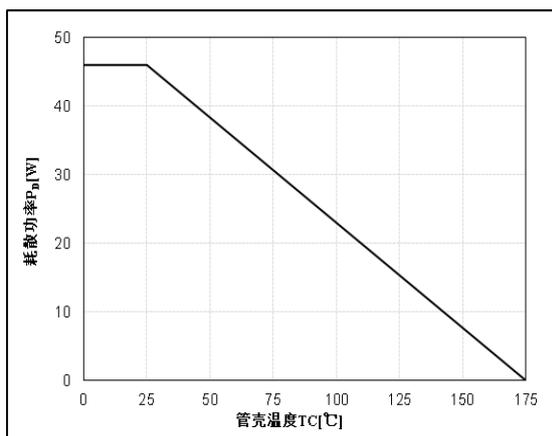
图 17 耗散功率温度特性 ( $T_J \leq 175^\circ\text{C}$ )
