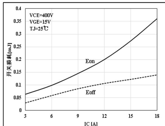
图 12 开关损耗的电流特性
